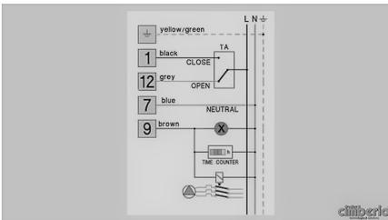
L'allacciamento elettrico deve essere eseguito da personale autorizzato e conformemente alle normative locali rispettando lo schema allegato e la correttezza della tensione di alimentazione.
