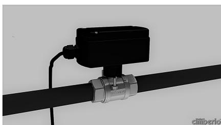
L'attuatore è collegato alla valvola a sfera mediante un dado esagonale di bloccaggio. Il dado esagonale di bloccaggio è a protezione e assicura l'antisvitamento della capsula premistoppa della valvola a sfera.
