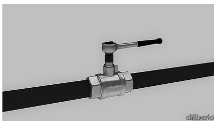
Con supporto disinstallato si può svitare il premistoppa mediante una chiave a bussola. Prima di effettuare questa operazione, depressurizzare l'impianto ed assicurarsi che valvola a sfera sia completamente chiusa. Se necessario sostituire le tenute idrauliche. Per riassemblare la valvola ripetere le operazioni precedenti in ordine inverso.
