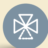
Válvula de 3/4 vías con actuador 3/4 ways valve
