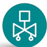
Valvola di controllo e bilanciamento a orifizio variabile Variable orifice control and balancing valve
